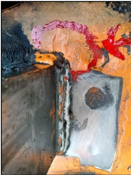
Local: Estrutura geral Item # 02: trinca no canto da viga telescópica lado flipper vermelho/preto. Status: corrigido
