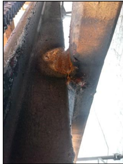
Local: Estrutura geral Item # 02: trinca no canto da viga telescópica lado flipper branco/verde. Status: corrigido
