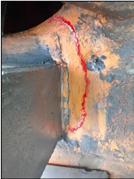
Local: Estrutura geral Item # 02: trinca no canto da viga telescópica lado flipper branco/verde. Status: corrigido
